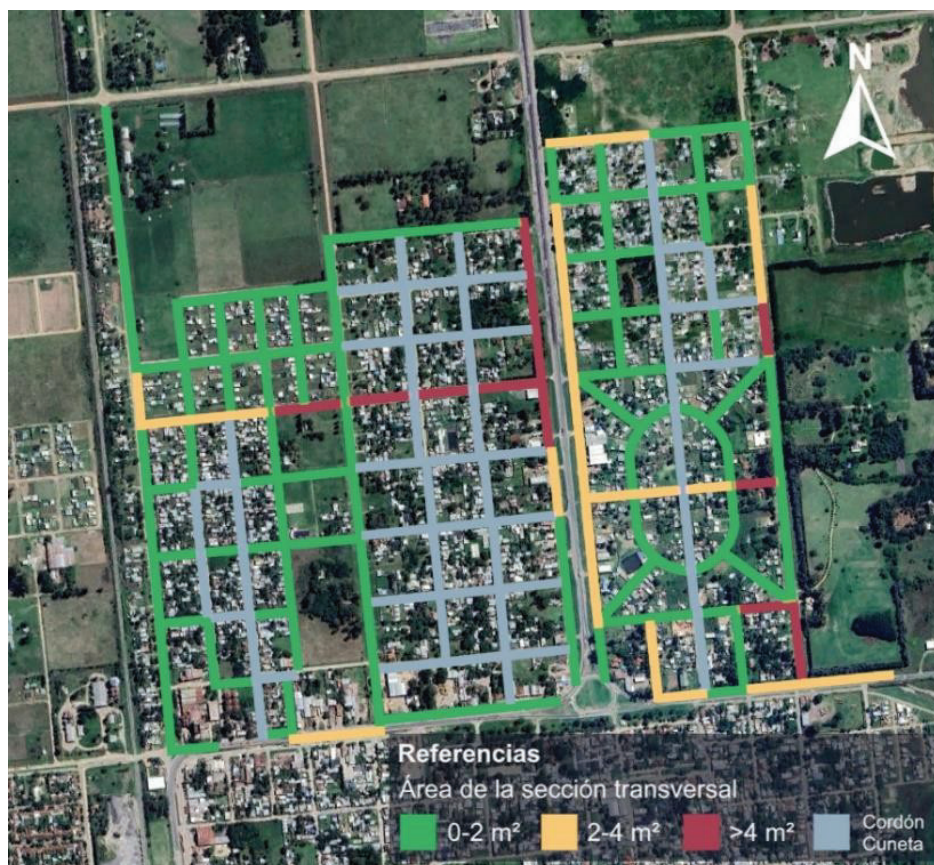
Ilustración 21 - Área de la sección transversal de las cunetas del CPN.
