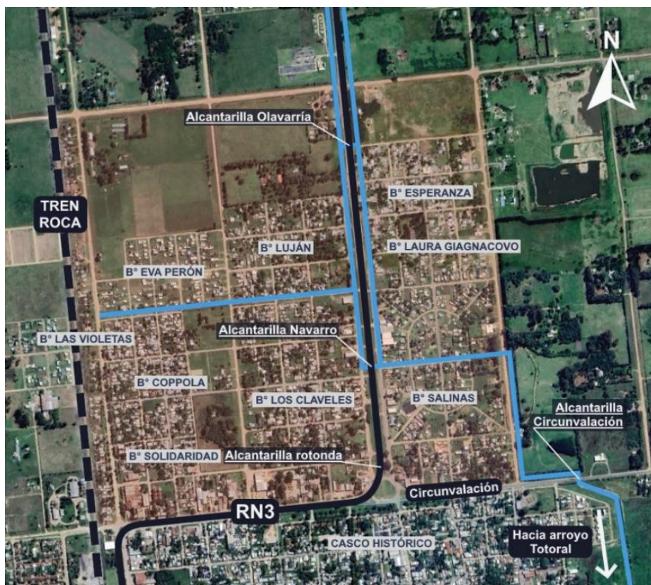
Ilustración 20 - Cunetas principales del desagüe pluvial del CPN.
